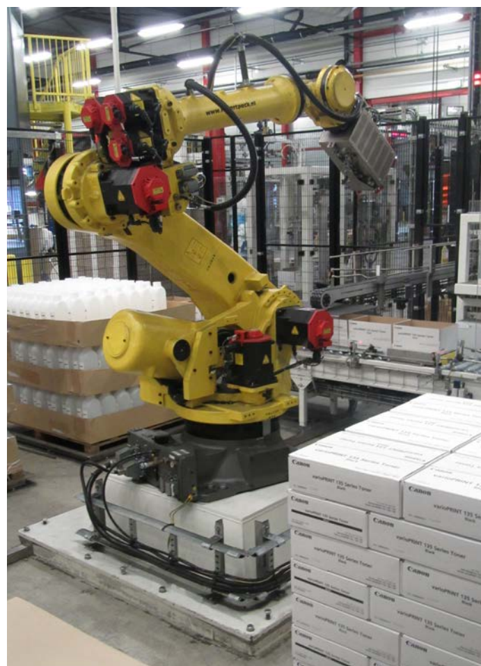
De robot plaatst lege flessen van de stapel links op de aanvoerband. Volle flessen (rechtsboven) plaatst hij in de doos, waarna de robot de volle, afgesloten dozen palletiseert.
