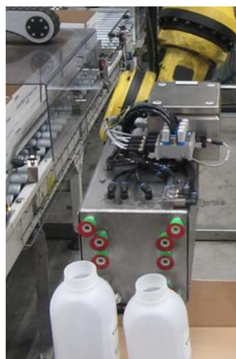
De multifunctionele grijpkop is geschikt voor het oppakken van flessen, dozen en pallettussenvellen.
